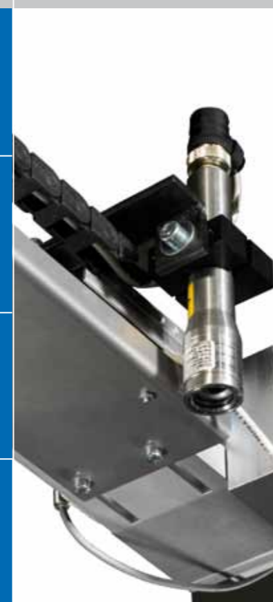
Ein Laser zeigt automatisch die genaue Position des Pappkerns auf den Aufwickelwellen an.
