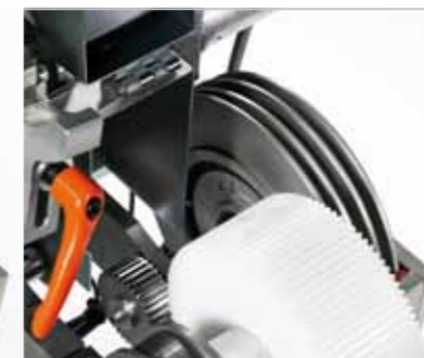
Der schnelle Wechsel der Mutterrollen erfolgt über 2 Klemmhebel der Abwickelwelle. Eine achslose Aufnahme ist optional erhältlich.
