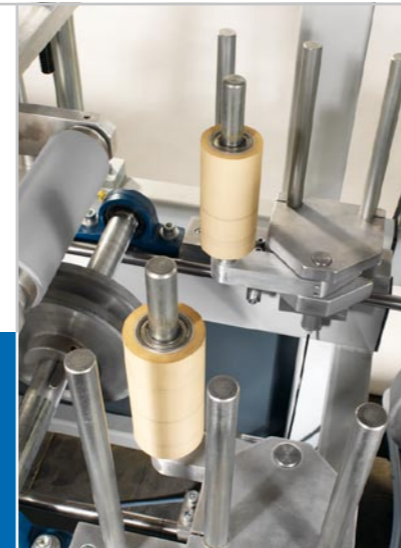
Ausgefeilte Mechanik: Die drei Rollen für die Seitenführung lassen sich mit einem Handgriff parallel verstellen...
